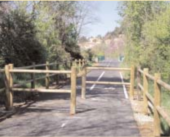
16- Voie verte à l'entrée d'Apt dans le Lubéron avec deux demi-barrières dont la première est, comme ici, à placer à gauche dans le sens de l'approche de l'intersection à venir
